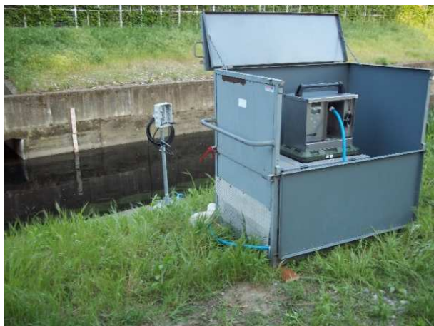
Figura 33 – Autocampionatore installato sul T. Seveso
